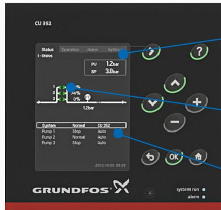
Presión en la descarga y punto de ajuste
